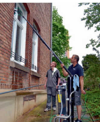
Die Reinigungsprofis Daniel Weinheimer (r.) und Jürgen Merz können mit dem neuen Deionisator-Gerät Fenster bis in 20 Meter Höhe reinigen.
